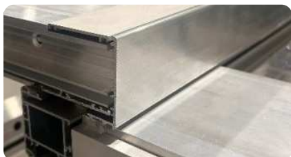
1 · O perfil é cortado à medida antes da lacagem
